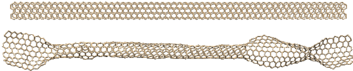
3. ábra: 14.101 nm hosszú bemeneti modell és az állandósult szerkezet.
