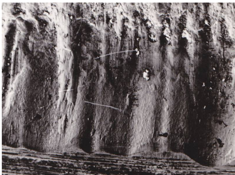
6. ábra. Forgácsolószerszám kopott homloklapja az eredeti köszörült állapotban maradt élszalaggal (alul).
