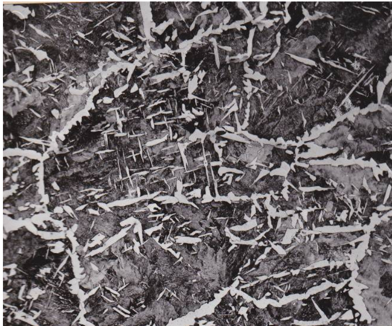
16. ábra. A kísérleti C45 acél Widmannstätten-jellegű + perlités szövetszerkezete.
