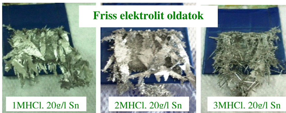
3. ábra Jellemző katódos leválások 10g/l-es ón koncentráció és 1-2-3 mólos friss elektrolit oldatoknál (1:1 nagyítás).
