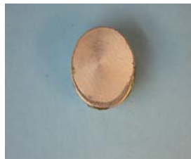
6. ábra A zömítések során kapott próbadarabok 'körte jelleű alakja
