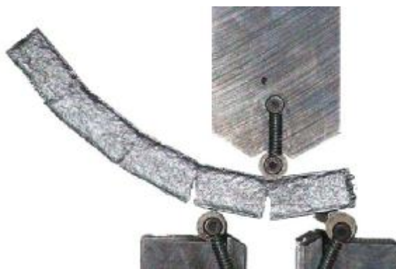
6. ábra: Dupla kompozit próbatestek hajlítóvizsgálata
