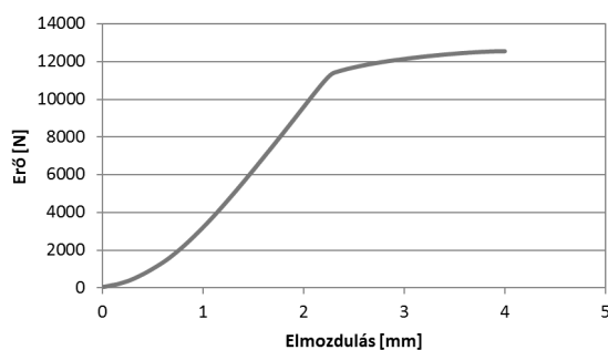
3. ábra. Alumínium 7075T6 anyag szakítódiagramja
