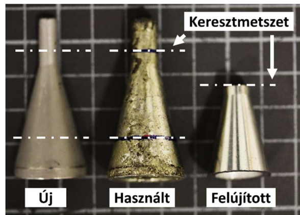
1. ábra: Új, használt és felújított fúvóka a mintavétel helyének jelölésével
